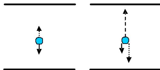
**Abb. 1:** Feldkraft (gestrichelt), Reibungskraft (punktiert) und um den Auftrieb verminderte Schwerkraft für ein sinkendes und steigendes Öltröpfchen im Plattenkondensator.
